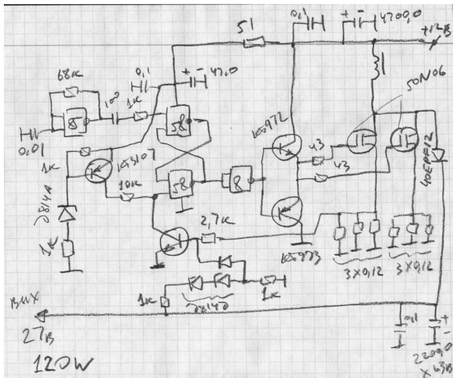
ТЩАТЕЛЬНОЙШИМ ОБРАЗОМ ПРОВЕРЯЕМ СХЕМУ НА ОШИБКИ- подобные игрушки неточностей не прощают. Включаем на выход номинальную нагрузку, включаем параллельно частото задающему конденсатору (0.01 мкФ) конденсатор с номиналом в 20...50 раз больше.
