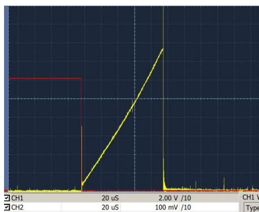
Проверяем длительность импульса- в моём случае- 100 мкс. Минимальный период частоты тактового генератора при том режиме работы, что хотелось бы заложить в данную схему, должен составлять, минимум, вдвое больше- 200 мкс, т. е. максимальная частота тактового генератора- 5 кГц. Отключаем питание.
