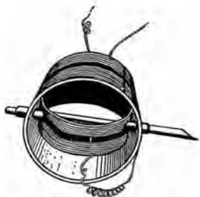
Рис. 9. Схема вариометра: одна катушка внутри другой
